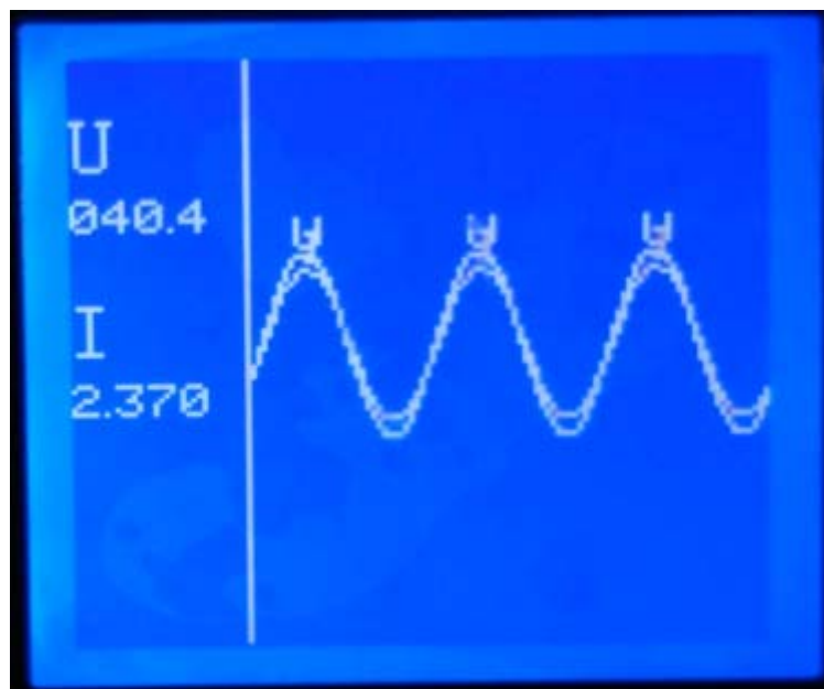
图 4-5 电量监测仪显示电压、电流参考波形
