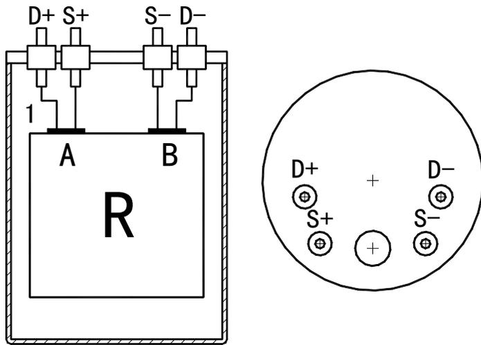
2. 错误的测试连接方法。如果采用下图的连接方法测试。测试结果包含了 S+、S-端至 A、B 端的引线电阻。当被测标准电阻值很小时，将引入较大的误差。
