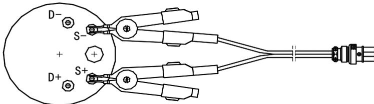
3. 正确的连接方法如下图所示，采用四端分开的测试线，以便消
