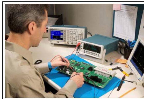
DMM4020在一台仪器中提供了电压、电阻、电流和频率测量功能。
